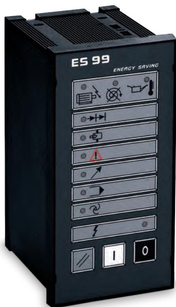
El ES99 ofrece un panel de control directo, proporciona un conjunto completo de los mensajes de advertencia para simplificar las operaciones diarias. Además, el software del ES99 adapta el tiempo de carga/descarga al consumo real de aire comprimido, evitando que el motor eléctrico esté en marcha cuando no es necesario.
